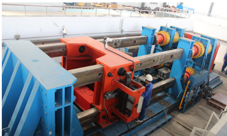
● 2000T 全尺寸石油管材复合加载试验台
