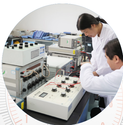
● 电学室绝缘电阻表检定装置
